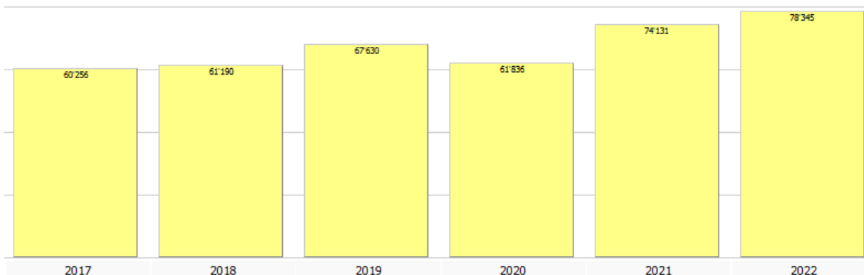
Abbildung 3.8.2: Flächenbezogener, temperaturbereinigter Wärmeverbrauch der Kirche
